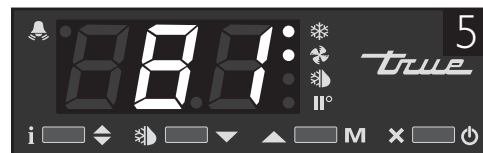
Image 4 : Si « oui » apparaît à l'écran, le contrôleur est verrouillé.
