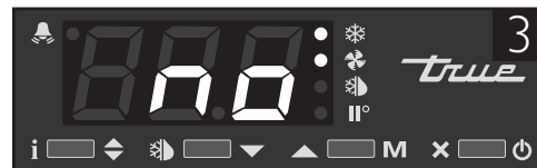
Image 3 : Si « non » apparaît à l'écran, le contrôleur est déverrouillé.
