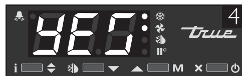
Image 4 : Si « oui » apparaît à l'écran, le contrôleur est verrouillé.
